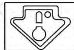
Проверьте, что на индикаторе температуры четко отображается слово **ОК**. (рис. 9). Если **ОК** не отображается на индикаторе, то это означает, что температура в холодильной камере слишком высокая. Отрегулируйте температуру в самой холодной зоне и подождите около 10 часов. Проверьте показание на индикаторе. В случае необходимости выполните регулировку повторно.
